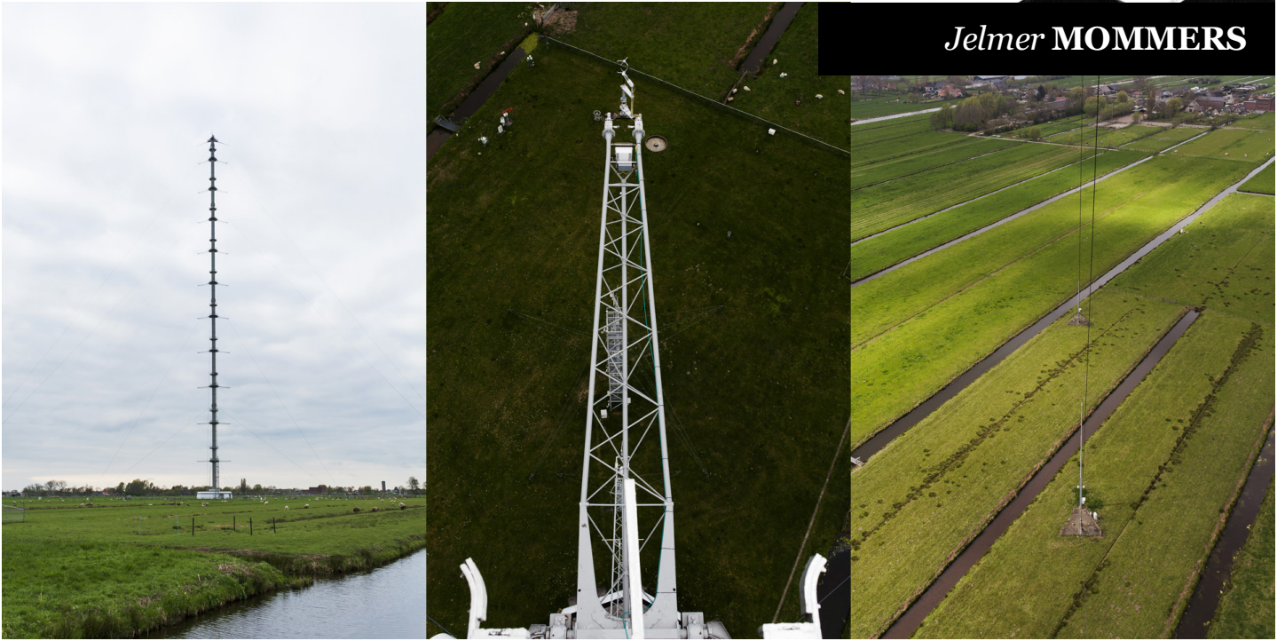
De meetmast, volgehangen met apparatuur om methaangas te meten, in het weiland bij het dorpje Cabauw. Foto's: Nick van Tiem (voor De Correspondent)
